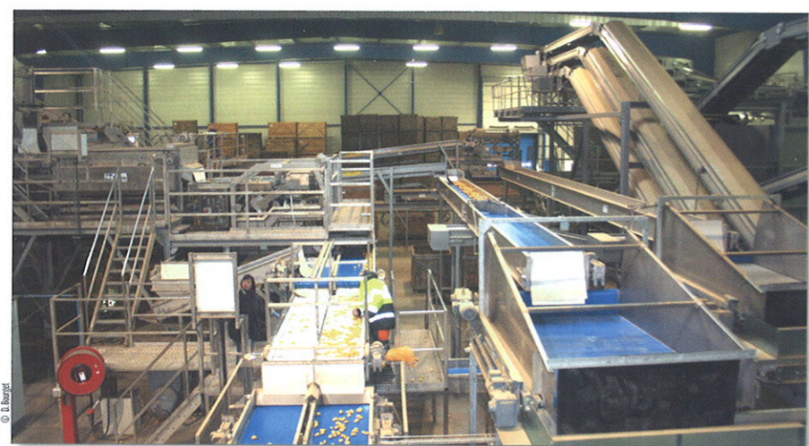
Le centre : vue sur les trois lignes de lavage dont l'une est équipée d'un trieur optique.
